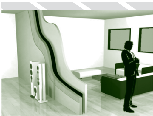
Aislamiento acústico en muros divisorios
